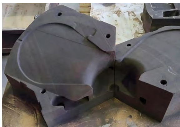
На фото: элементы литейной формы для винта, распечатанные на 3D-принтере
